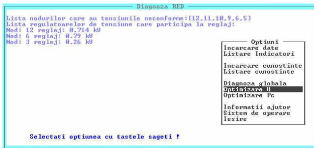
Figura 10. Optimizarea valorilor tensiunilor nodale Figure 10. Optimizing the values of bus voltages
