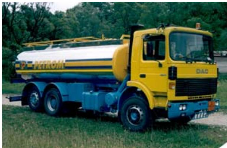
**Figura 4.2 - Autovehicul cisterna pentru transport produse petroliere - 24 CC**
